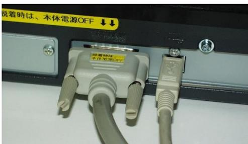
USB ケーブルを RPS-4800 背面に接続します。もう片方を PC の USB ポートに接続します。
