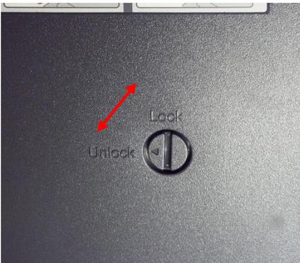
透過原稿ユニットの内側にあるキャリッジロック (輸送時固定ネジ) を Unlock 側へ回転します。輸送時には、Lock 側へ回転します。
