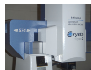
3次元測定機を用いてCr蒸着のマーカーを計測します。
